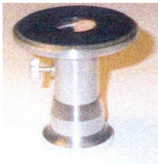
Figure 15 : microtome à main de Ranvier
